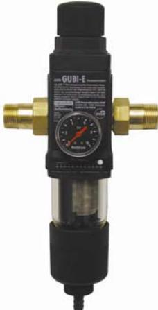
Αυτοκαθαριζόμενο φίλτρο νερού, θερμοκρασίας λειτουργίας έως 30 °C με μηχανισμό αναστροφής της ροής, μειωτή πιέσεως ρυθμιζόμενο από 1,5 έως 6 bar, μανόμετρο ένδειξης της πίεσης εξαγωγής και πιστοποίηση για πόσιμο νερό βάσει των Γερμανικών κανονισμών DVGW – TUV – DIN 19632. Ιδανικό για δίκτυα με υψηλές πιέσεις όπου και απαιτείται ρύθμιση.
